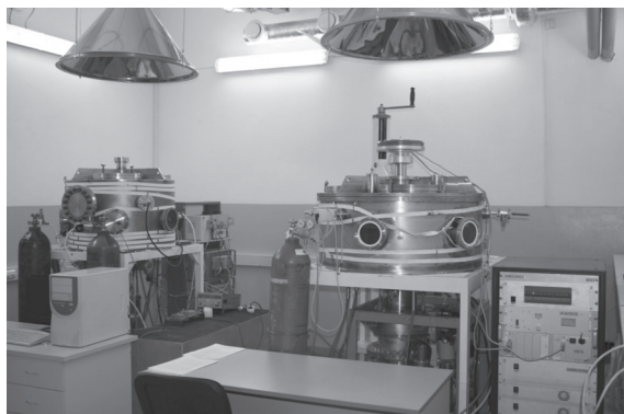
Рис. 1. Фотография “бериллиевой” лаборатории с установками магнетронного распыления.
