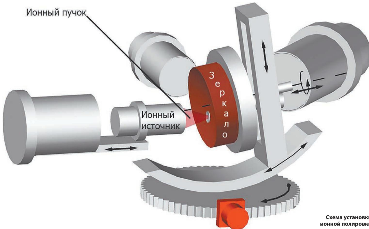
Схема установки ионной полировки
